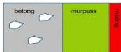
Fraksjoner på vegg som kan inneholde PCB.
