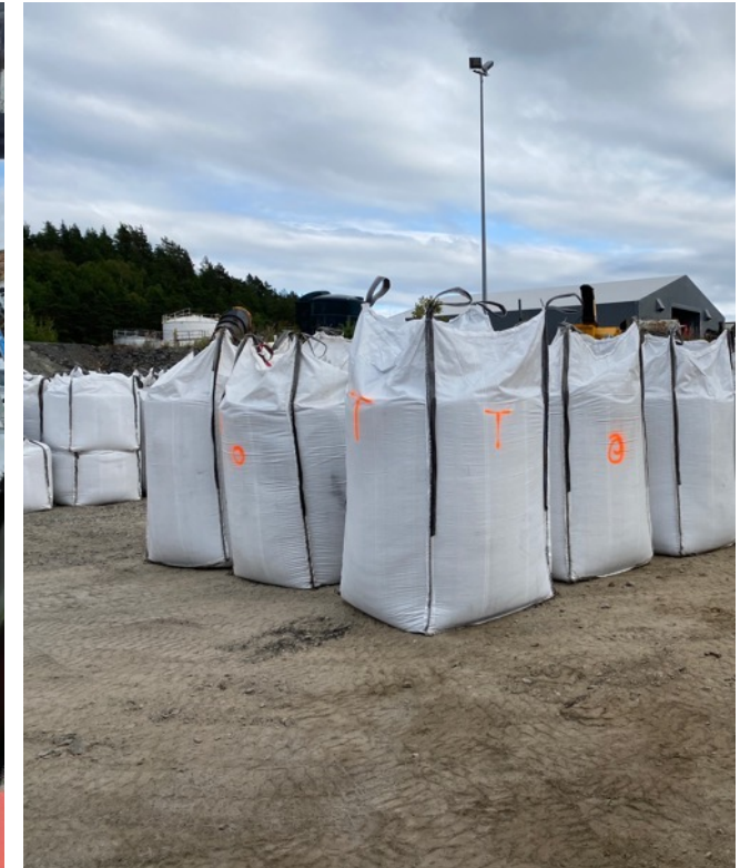
Sand og SBR/TPE/EPDM fjernes, renses, tørkes og plasseres i big-bags, klargjort for gjenbruk
